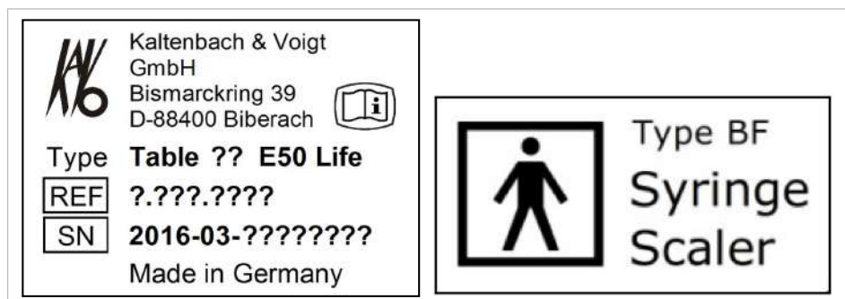
Plaque signalétique Élément praticien (ex. tablette TM) / Marquage des parties appliquées de type BF
